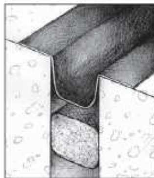
Cordon coupe-feu LITAFEU® avec membrane d'étanchéité
