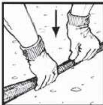
Avant que la colle ne sèche, introduire le cordon LITAFEU® en force
