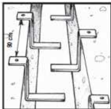
Positionner les équerres en quinconce tous les 90 centimètres
